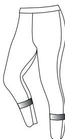
En rad reflex runt ben. variant: BX 251. 25 mm reflex. variant: BX 501. 50 mm reflex.
